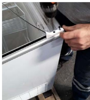
7. Atornillar los plásticos que fijan los vidrios laterales en el perfil, tal y como muestra la imagen.
