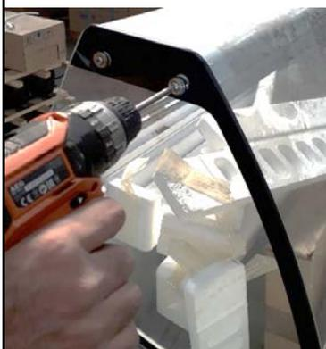
6. Posteriormente, atornillar los vidrios laterales a la rejilla. En total son 4 tornillos, dos para el lateral derecho y dos para el izquierdo.
