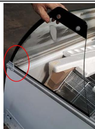
4. Tras el montaje de los vidrios laterales y de la pantalla parabrisas, empujar la parte frontal indicada en la imagen.
