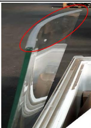
3. Verificar la correcta posición de las juntas de goma situadas a ambos lados de la pantalla parabrisas.
