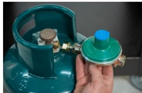
**1.** Vissez le régulateur de gaz dans le robinet de la bouteille et tournez manuellement le boulon dans le sens inverse des aiguilles d'une montre. Utilisez une clé spéciale pour régulateur de gaz pour un serrage parfait et pour éviter d'endommager le joint de la vanne, compromettant ainsi l'étanchéité.
