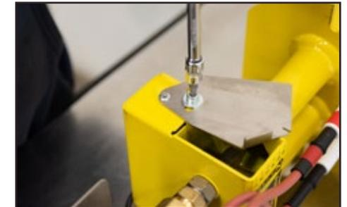
**2 - Retirez la vis située sur le régulateur d'air**
