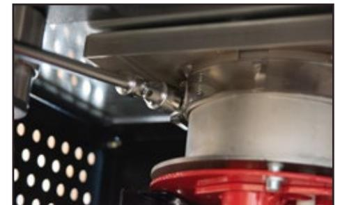
**4 - Démontez le dispositif de fixation du brûleur**
